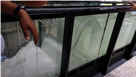
SIPHON SPILL WAY
